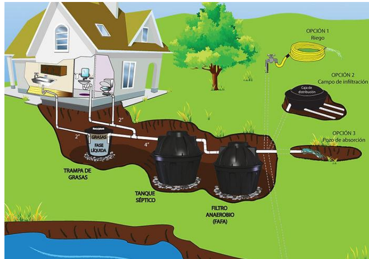
Figura 49: Sistema séptico cónico esférico diagrama
